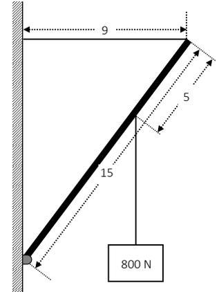
15B La tangente del ángulo que forma con la horizontal la fuerza que ejerce la bisagra sobre la viga tiene un valor exacto de:
